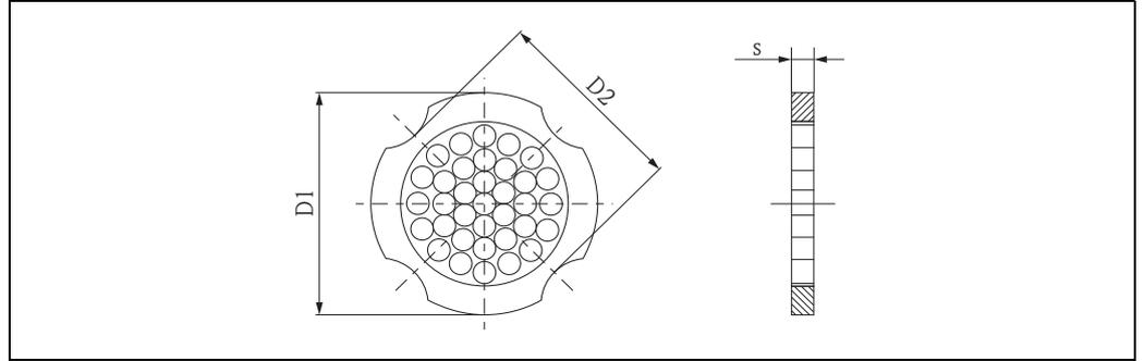
D1: 流量调节器安装的螺孔间的外圆周上
