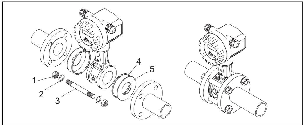
夹持式仪表的安装示意图
