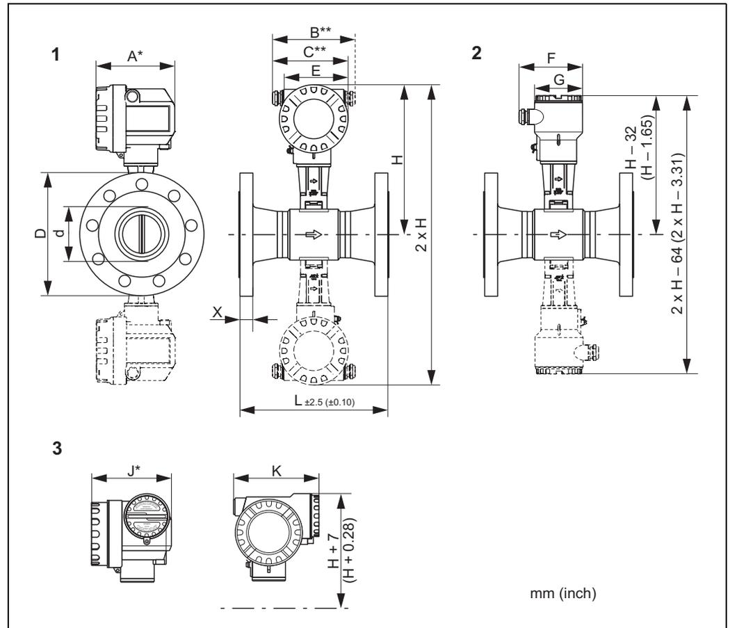
1 = 标准型、Ex i/IS 型和 Ex n 型; d: 连接管内径
